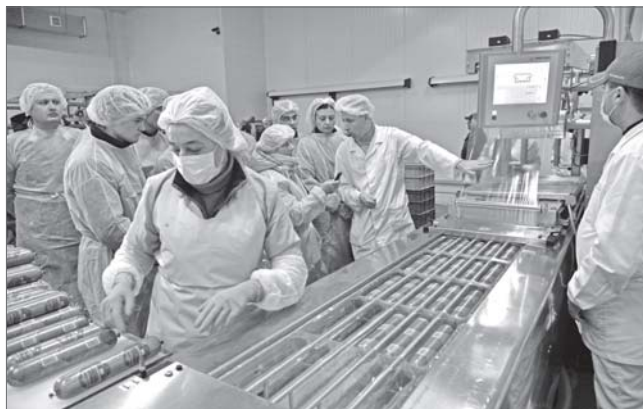
Линия вакуумной упаковки частично автоматизирована.
